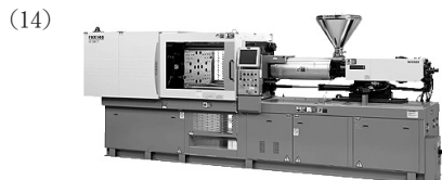
射出成型機 FNX 140-25 A。日精樹脂工業株式会社 (http://www.nisseijushi.co.jp/: 2006/06/02)。
