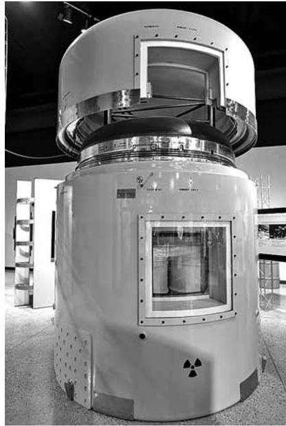
写真13 核廃棄物を格納するためのコンテナ。上部の蓋がすこし浮いた状態で展示されている。高さ3m近くあるだろうか。模型なのか実機を加工したものなのかは不明。
